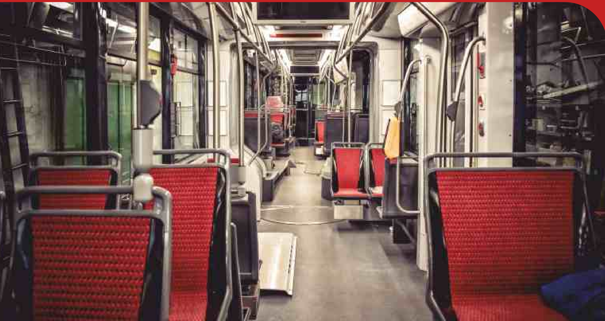
Drak je prvním plně nízkopodlažním typem tramvají v Brně a také první tramvají s klimatizací prostoru pro cestující.
